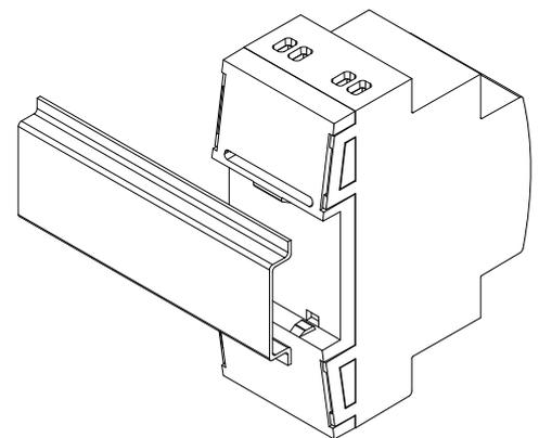
Figure 3. Montage du MINiBOX DX1 sur rail DIN
