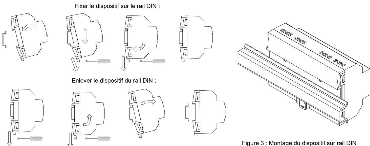
Figure 3 : Montage du dispositif sur rail DIN
