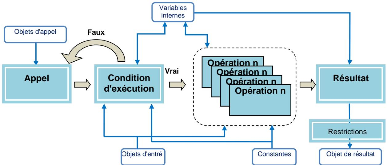
Figure 1. Diagramme de fonctionnement des fonctions logiques.
