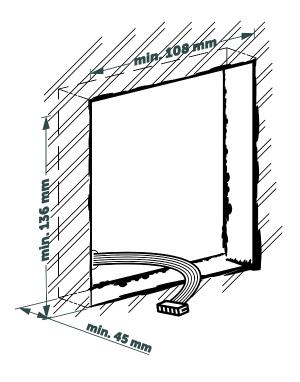
2 Installez le boîtier en utilisant un mortier, un ciment-colle ou un matériau de construction similaire. Respectez l'orientation et récupérez les câbles.
