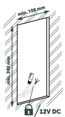
Placez le boîtier, récupérez les câbles et fixez-le avec les vis qui ajustent la profondeur. Faites spécialement attention à l'orientation du boîtier.
