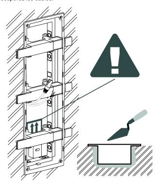
4 Après le temps de prise, retirez les pièces auxiliaires et cassez les fenêtres.
