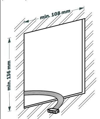
Placez le boîtier, récupérez le bus et fixez-le avec les vis qui ajustent la profondeur. Faites spécialement attention à l'orientation du boîtier.
