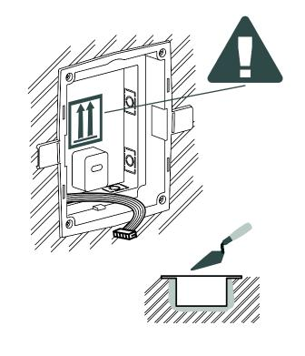
**3** Après le temps de prise, retirez les pièces auxiliaires et cassez les fenêtres.
