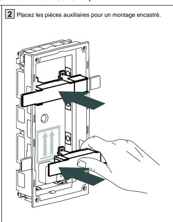
Installez le boîtier en utilisant un mortier, un ciment-colle ou un matériau de construction similaire. Respectez l'orientation et récupérez les câbles.
