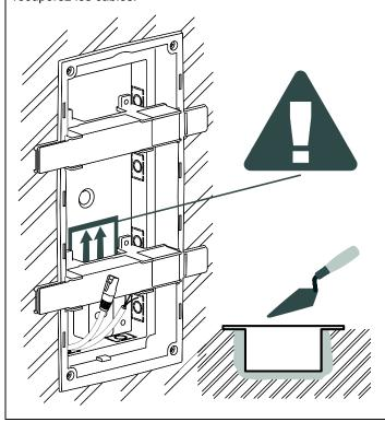
Après le temps de prise, retirez les pièces auxiliaires et cassez les fenêtres.
