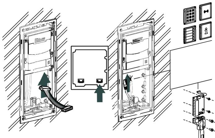
**4** Fixez le cache (ou les modules additionnels en façade) avec les vis fournies et placez les étiquettes avec les identifiants en regard de chaque bouton.
