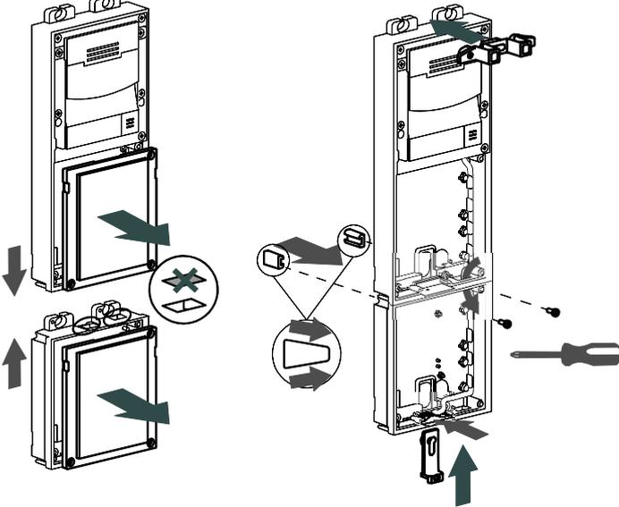
**2** Insérez le support dans le boîtier encastré tout en récupérant les câbles. Vissez le support (vis incluses).
