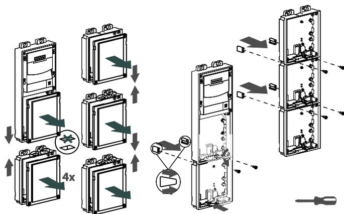
**2** Placez les pièces métalliques auxiliaires fournies avec les cadres. Insérez les supports dans les boîtiers encastrés tout en passant le bus et en récupérant les câbles.
