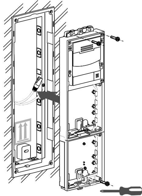
**3** Connectez le câblage de l'unité basique et placez les modules additionnels en assurant la connexion du bus comme indiqué dans le schéma.
