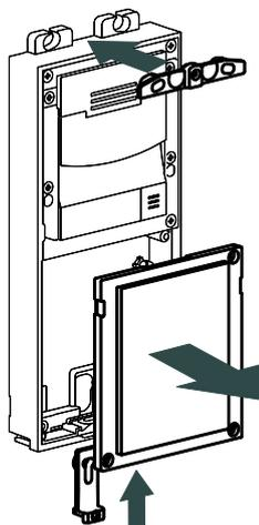
**2** Insérez l'unité basique dans le boîtier encastré tout en récupérant les câbles. Vissez le support (vis incluses).
