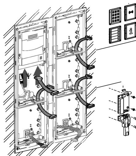
**5** Faites la connexion du bus comme indiqué sur le schéma et vissez les modules additionnels en façade.
