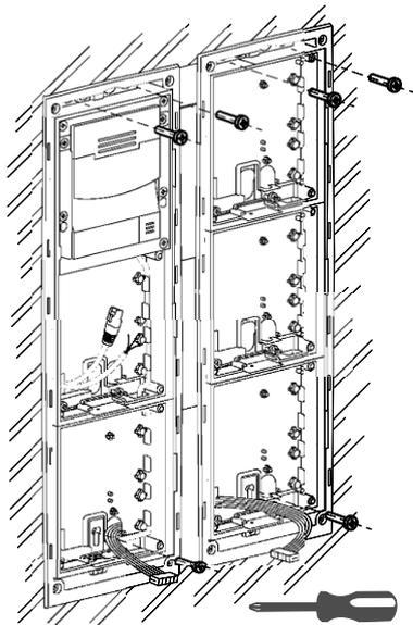
**4** Faites les connexions de l'unité basique et préparez les modules additionnels. Passez les câbles du bus dans les fenêtres prévues à cet effet.
