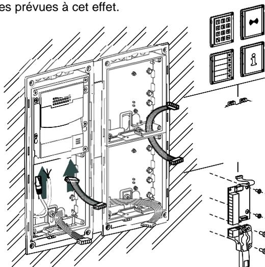
**5** Faites la connexion du bus comme indiqué sur le schéma et vissez les modules additionnels en façade.
