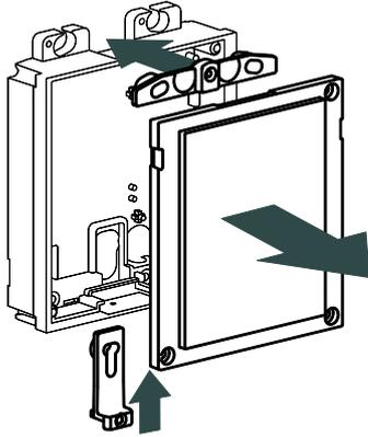
**2** Insérez le support dans le boîtier encastré tout en récupérant les câbles. Vissez le support (vis incluses).
