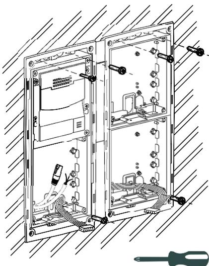
**4** Faites les connexions de l'unité basique et préparez les modules additionnels. Passez les câbles du bus dans les fenêtres prévues à cet effet.
