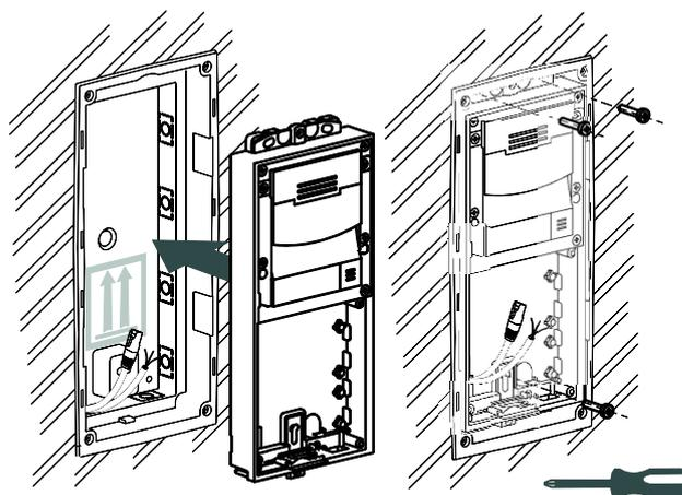
**3** Connectez le câblage de l'unité basique et placez les modules additionnels en assurant la connexion du bus.
