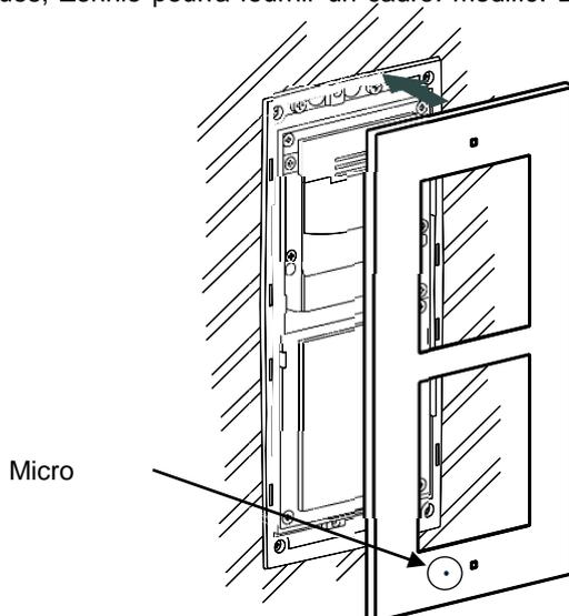
**2** Introduire le câble du microphone au travers du trou de l'unité basique comme indiqué sur l'image. Après cela, connectez-le à la connexion "MIC" de l'unité basique.
