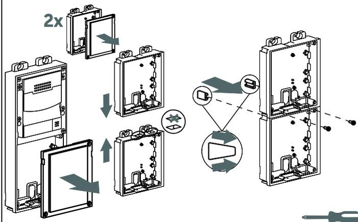
**2** Placez les pièces métalliques auxiliaires fournies avec les cadres. Insérez les supports dans les boîtiers encastrés tout en passant le bus et en récupérant les câbles.
