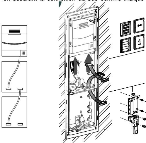
**4** Fixez le cache (ou les modules additionnels en façade) avec les vis fournies et placez les étiquettes avec les identifiants en regard de chaque bouton.
